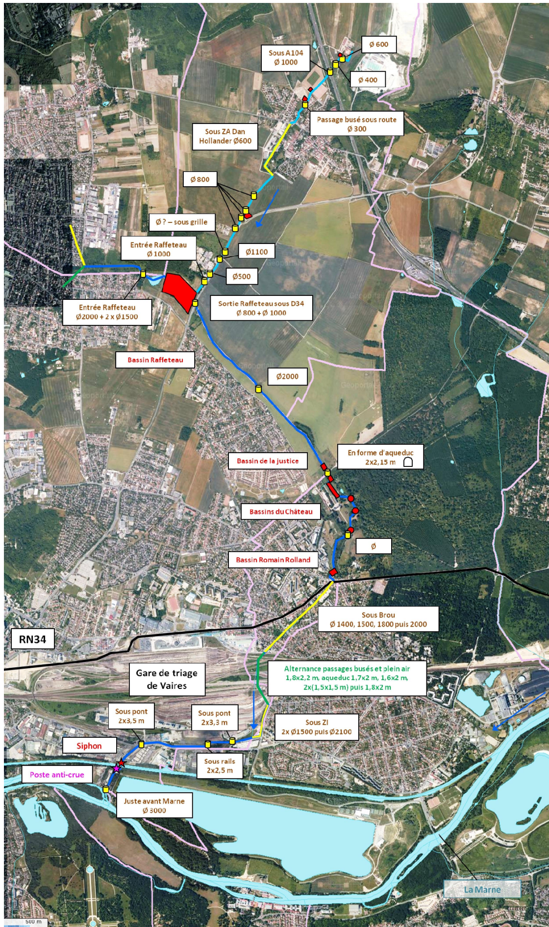
Principaux ouvrages situés sur les rus de Chantereine et de Courgain (schéma SEGI Ingénierie pour l'étude CAMC de 2011)
